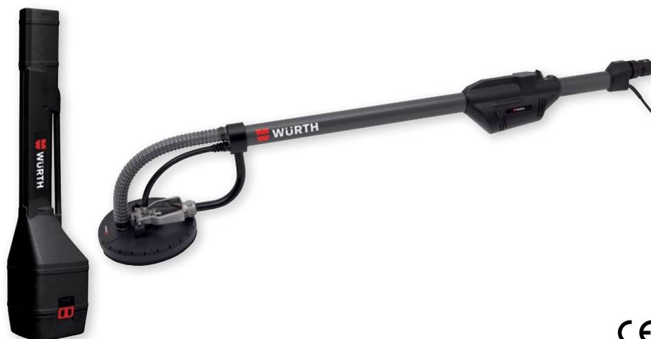
Fornita in robusto contenitore in plastica con platorello morbido Ø 225 mm/10 fori, (per lavori di finitura), 3 carte abrasive USeit® Superpad P Wood (grana 60, 80, 100), adattatore aggiuntivo per carta a velcro (per superfici lisce) e chiave esagonale 5 mm
