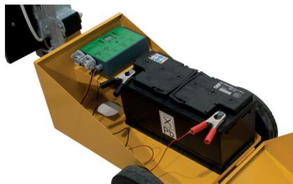
La centralina di controllo digitale gestisce e verifica il funzionamento di lampade e batteria. Di seguito vengono descritti tutti i comandi presenti nel pannello della centralina.
